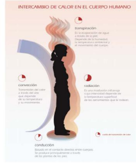
Figura 1. Intercambio de calor en el cuerpo humano Fuente: Mód. 3 Ambiente interior. Máster en Bioconstrucción IBN-IEB-Udl. Elaboración propia.
