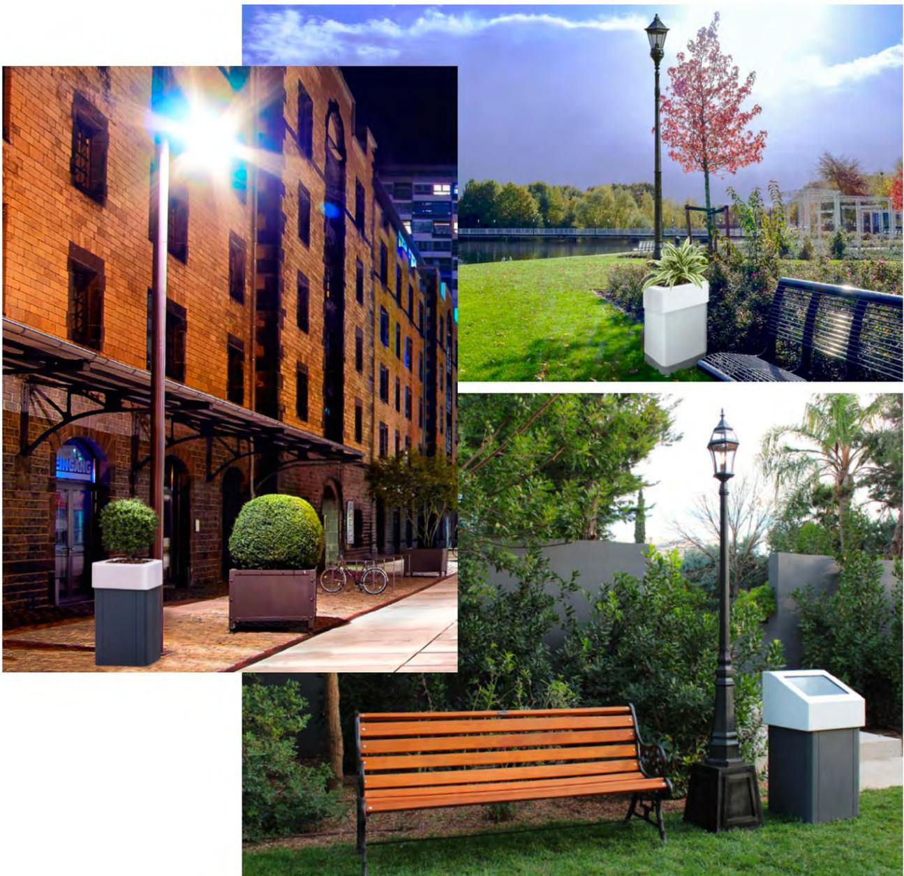
Fig. 3: Ejemplos de mobiliario urbano equipados con celdas pequeñas camufladas (en blanco), diseñadas para todas las bandas de frecuencia LTE/5G [5].
