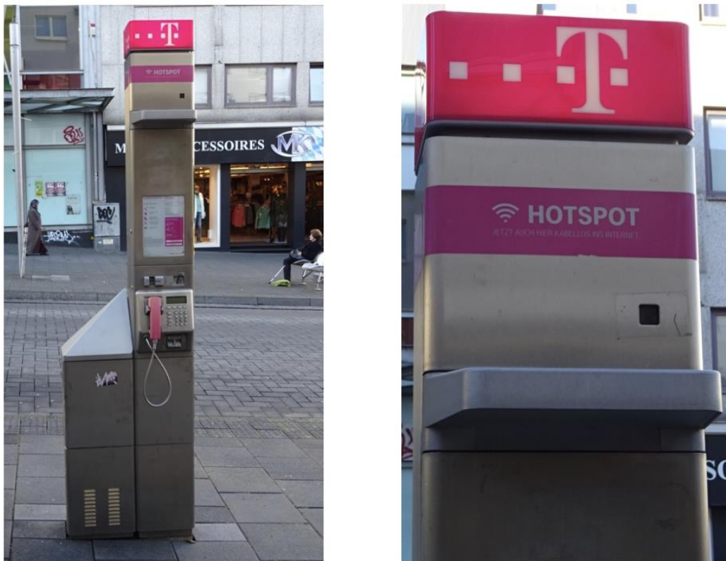
Fig. 6: La microcélula de Telekom con telefonía móvil LTE (hotspot) en una zona peatonal, lo cual ha sido una práctica común desde hace bastante tiempo.
